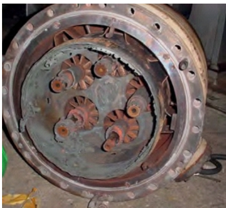
图9: 由于机器调谐不当导致的高频（2350 Hz）热声不稳定性造成的损坏 23 。
