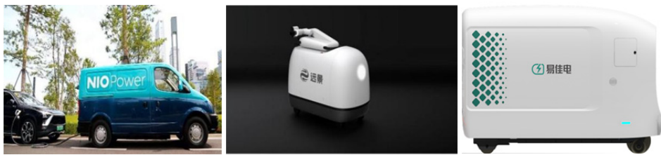
图 18 蔚来移动充电车（左）、远景摩奇智能充电机器人（中）、国轩智能移动储能充电桩（右）
