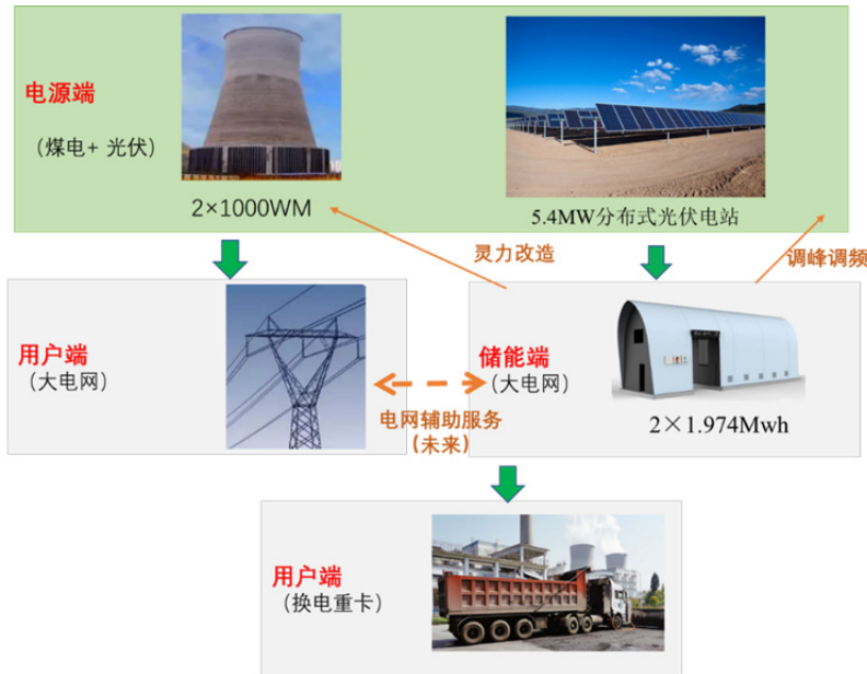
图 58 煤光储充一体化项目示意图
